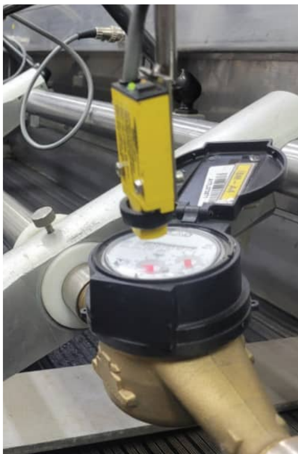
Bancada de sensores para medidores de agua
