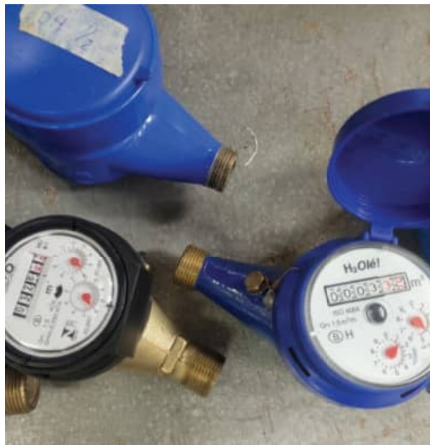
Medidores de agua potable
