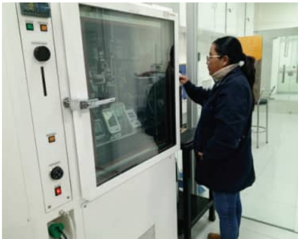
Personal de IBMETRO calibrando termómetros, para la industria médica
